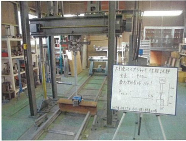
大径受パイプジャッキ性能試験
