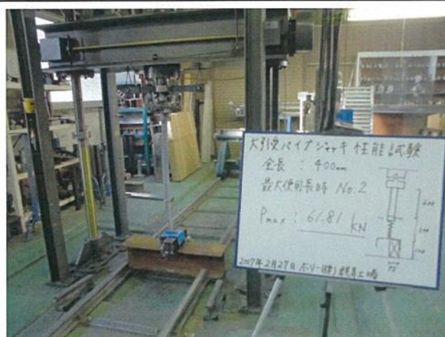
大径受パイプジャッキ性能試験
