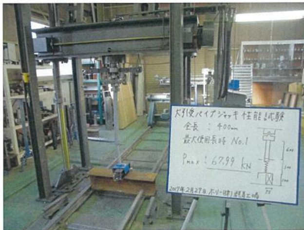
大径受パイプジャッキ性能試験
