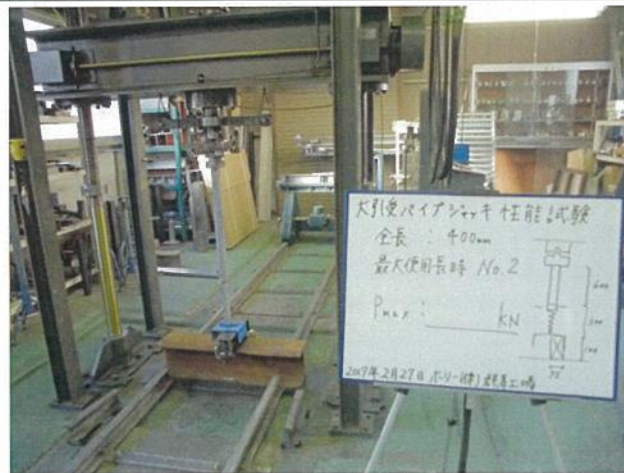
大径受パイプジャッキ性能試験
